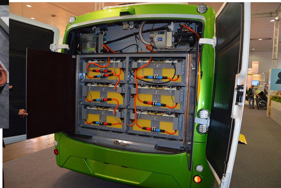
Traktionsbatterie eines Hybrid-Busses
