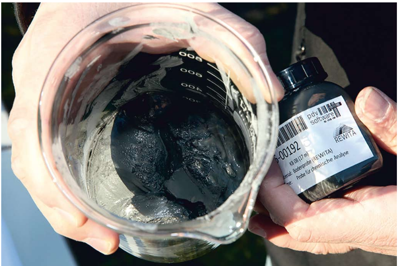
Reich an Indium, Gallium und Cobalt – Schlamm der Erzaufbereitung des Erzbergwerks Rammelsberg in Goslar
